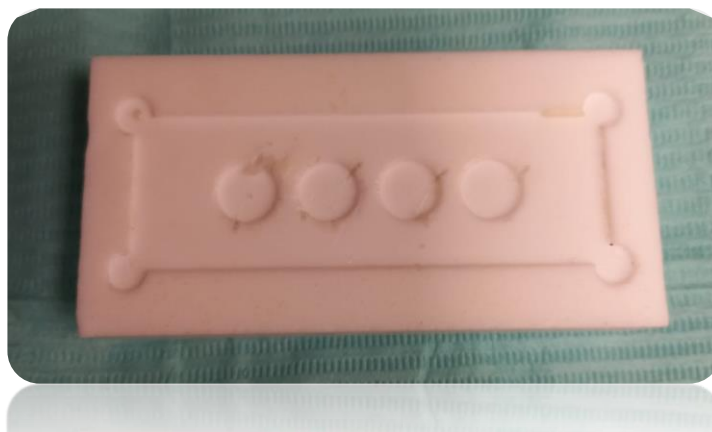
Figura 5. Molde de teflón para realizar los bloques de ionómero de vidrio modificado con resina con nanopartículas de Dióxido de Titanio al 3 y 5%
