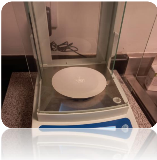
Figura 16. NPs de \text{TiO}_2 al 3% sobre la balanza analítica para ser pesadas.
