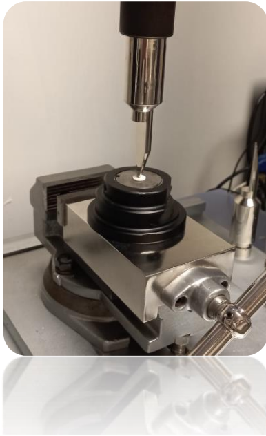
Figura 29. Bloque del grupo control con la presencia de punta plana de la maquina universal de ensayos en el centro de la muestra.
