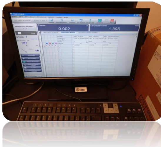
Figura 31. Registro de valores obtenidos en la computadora de la maquina universal de ensayos, para posteriormente ser registrados en la base de datos.
