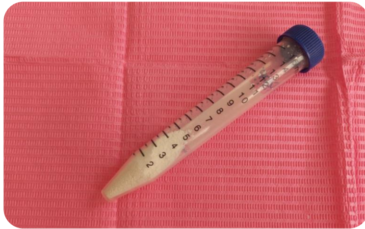
Figura 8. Nanopartículas de Dióxido de Titanio con un tamaño promedio de 10 nm fase anatasa en polvo.
